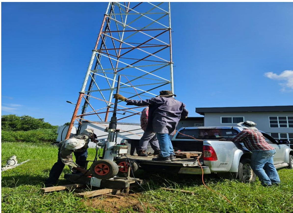
Figuur 41: C.P.T. uitvoering t.b.v. nieuwe mast Ishara TV.
