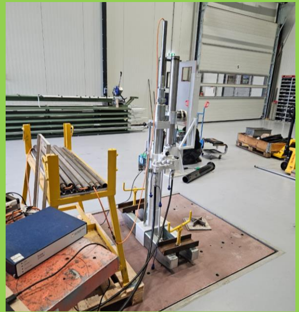
Foto 18: Testopstelling nieuw C.P.T. apparaat in de fabriek in Nederland (MOW-LGM, 2024)
