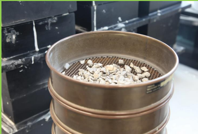
Foto 18: Zeefanalyse in uitvoering van steenslag sample (MOW-LGM, 2024)
