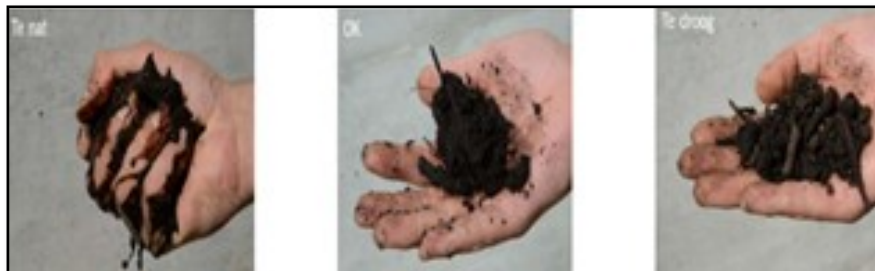
Foto 17: Vochtigheidsbepaling met behulp van de zogenaamde knijptest.
